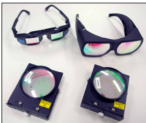
図-3.1-32 国立天文台 4D2U シアター用 Infitec 眼鏡とプロジェクタ用フィルタ
