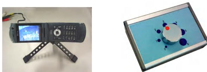
図 4.1-14 (左)2.5 インチ LCD、(右)調整用コントローラ
