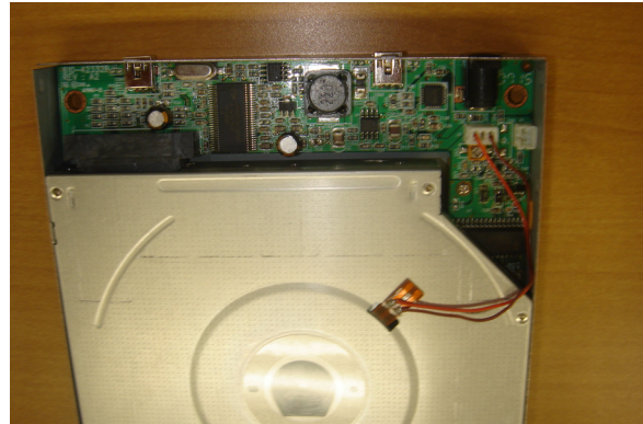
図 1.2.3.4-2 光ディスクドライブ回路と 一体型リーダ・ライタのドライブへの搭載
