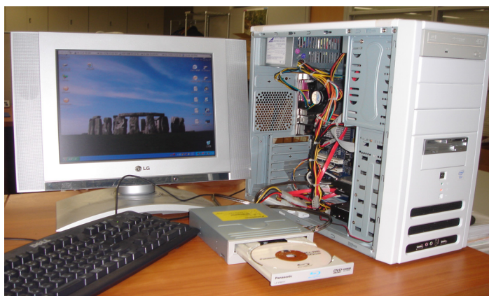
図 1.2.2-5 パソコンに接続した高度暗号チップ搭載 Blu-ray ディスクドライブ
