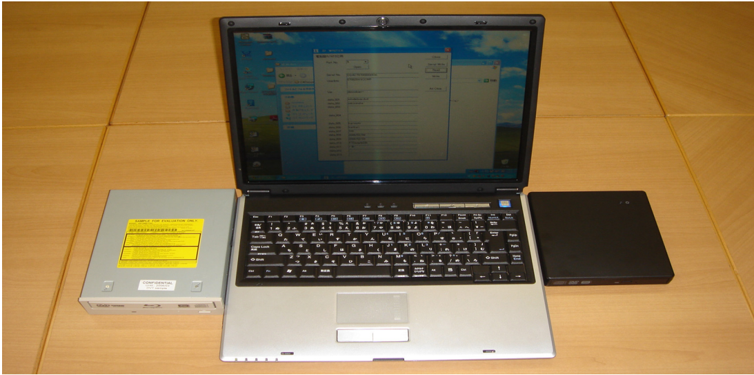
図 2.1.1-3 ノートパソコン（DVD-RAM 内蔵）に外部光ディスクを接続
