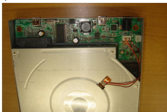
図 1.2.3.4-2 光ディスクドライブ回路と一体型リーダー・ライターのドライブへの搭載
