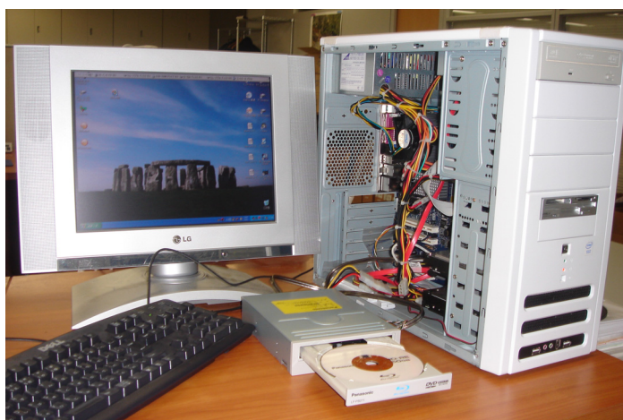
図 1.2.2-5 パソコンに接続した高度暗号チップ搭載 Blu-ray ディスクドライブ
