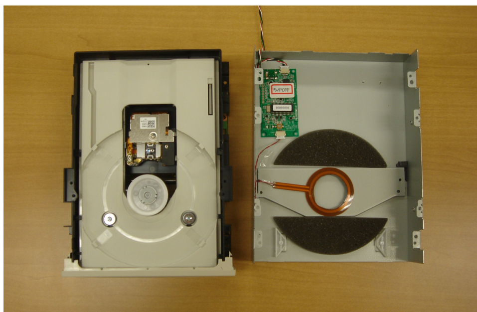
図 1.2.1-3 リーダ・ライタ側のアンテナを Blu-ray ドライブに搭載
