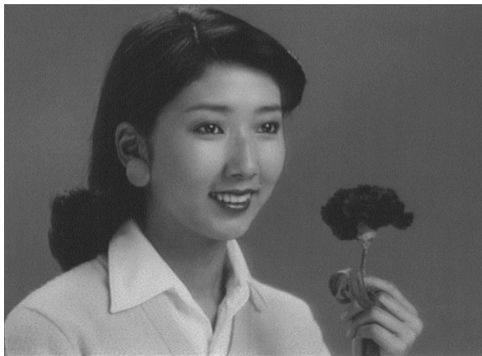
図 5-4 標準テレビ用撮像板での撮像例 (被写体照度 0.3 ルクス、光学レンズの絞り値 F1.2)
