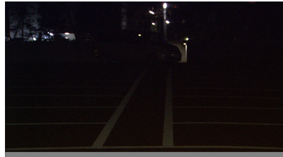
(d) CCD (アンプゲイン +18dB)
