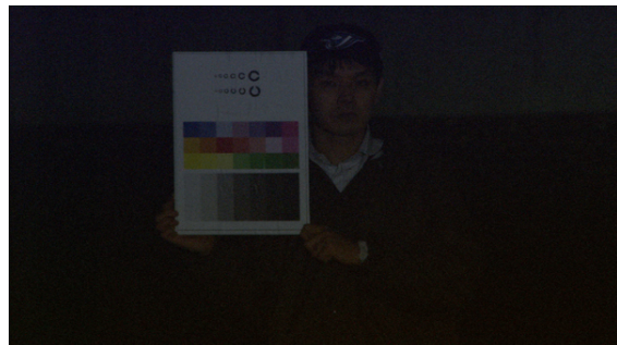
(d) CCD (アンプゲイン +18dB)
