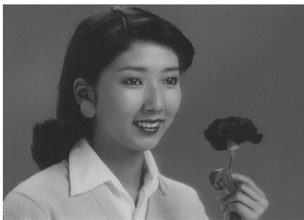
図 42 標準テレビ用撮像板での撮像例 (被写体照度 0.3 ルクス、光学レンズの絞り値 F1.2)
