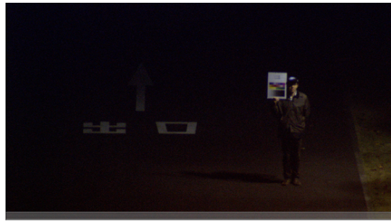
(b) CCD (アンプゲイン +18dB)
