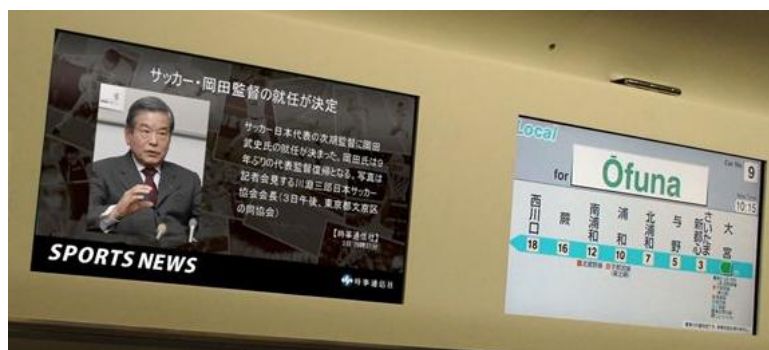
図 3.1.7-1 JR電車内ドア上に設置された液晶モニタ
