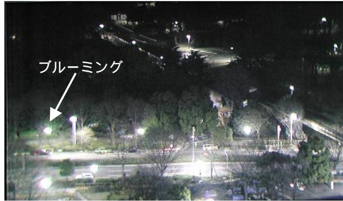
図 35 HARP 撮像管カメラでのブルーミング発生例
