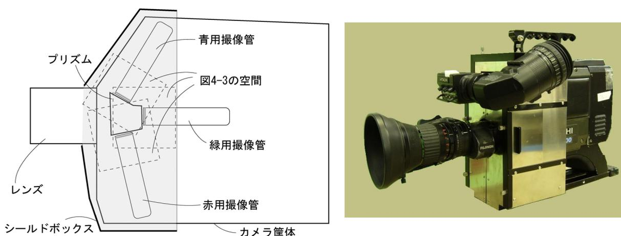
図 4 試作したシールドケース形状
