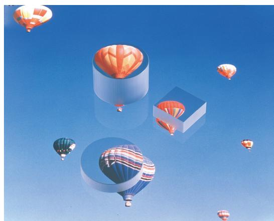
図 7 FOP による光学像伝達の例
