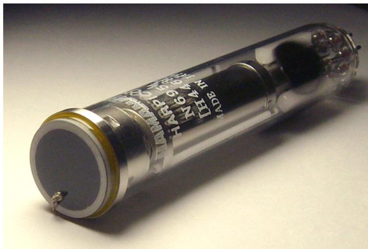
図11 試作した FOP-HARP
