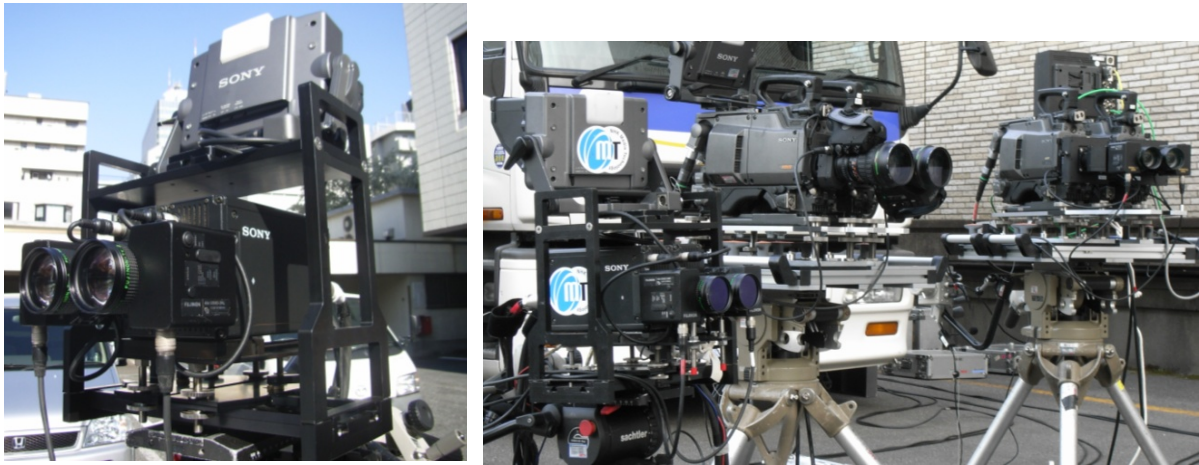
図 2.5-15 NHK HDC950 分離型方式リグ と 18 倍シンクロズームを装着した 3D カメラ (通称 フュージョンカメラ) (センターのカメラ)
