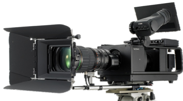
本体の大きさと重量 H200mm, W240mm, L480mm, 18kg 図 3.5-7 単眼レンズ カメラプロトタイプ
