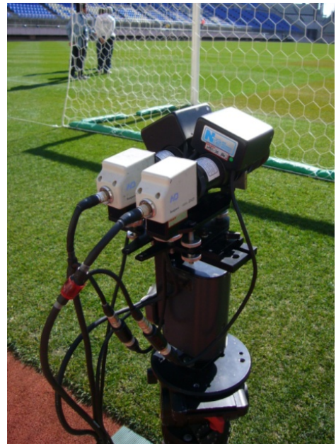
図 2.5-16 レンズシフトアダプタ付き 3D カメラと HDL-20 を 2 台使用した 3D 小型リモコンカメラ
