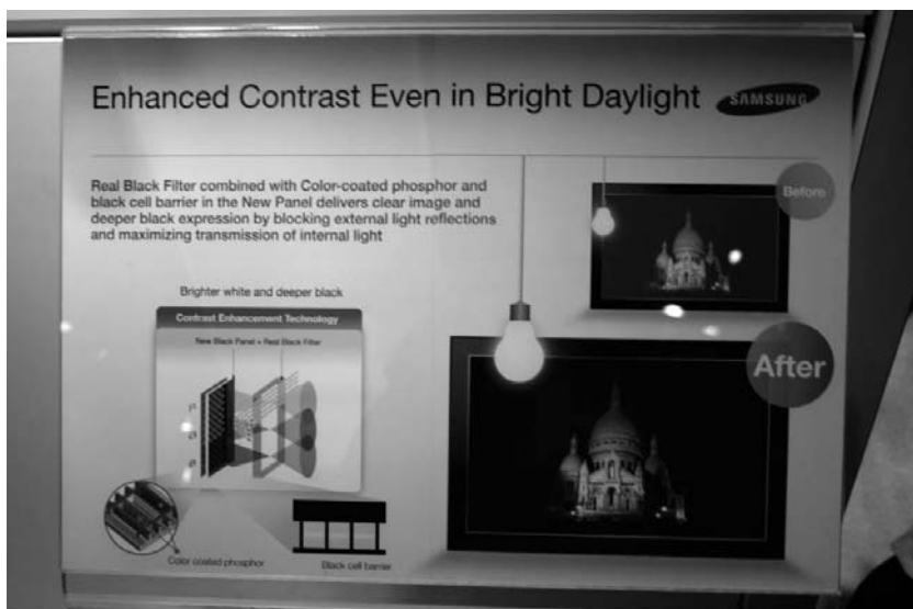
図 6.2-6 画面への外光侵入を防ぐ仕組み(裏では実験を実施)
