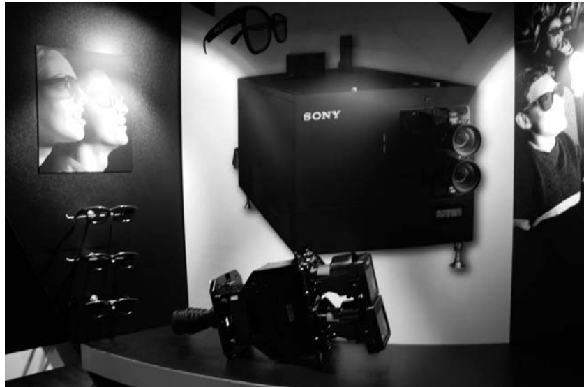
図 6.2-12 2 眼式のプロジェクタと液晶シャッターメガネの展示
