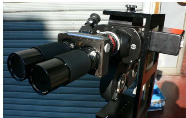
図 2.5-11 アリフレックス+アリビジョンと35mmフィルムカメラ「ミッチェル」に3Dレンズを装着したシステム
