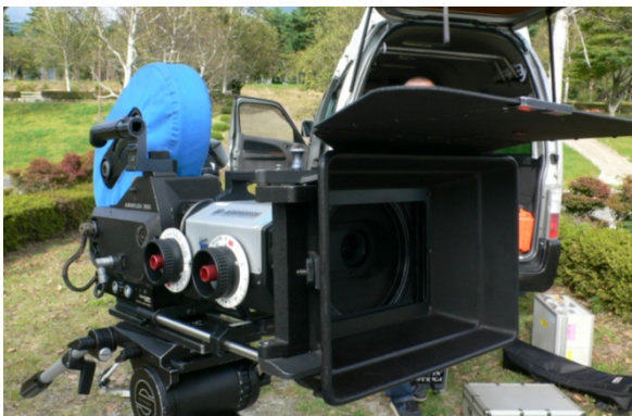
図 2.5-11 アリフレックス+アリビジョンと35mmフィルムカメラ「ミッチェル」に3Dレンズを装着したシステム
