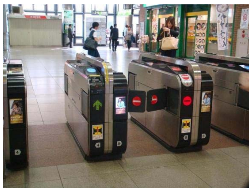
図 4.5.1-1 有機ELディスプレイ付き自動改札機とディスプレイ詳細
