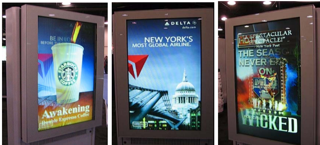
図 3.6.10-16 左：右側～正面にかけて見た図。スターバックスコーヒーのコンテンツからうっすらデルタ航空のコンテンツへと変化している。
