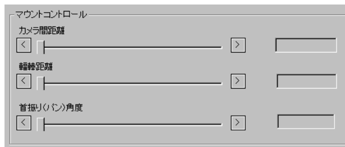
図 3-1.2-6 スライダバー制御(カメラ間隔,輻輳,など)
