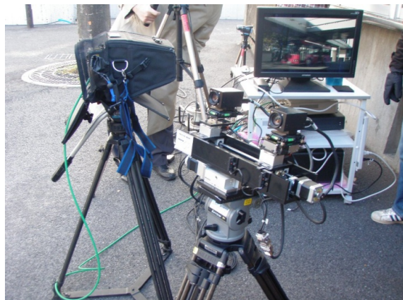
図 3-4.3-3 撮影時の 3D カメラシステム 3D カメラ 左の箱は、持参したカメラマン用モニター (2D、コントロールユニットより分配)
