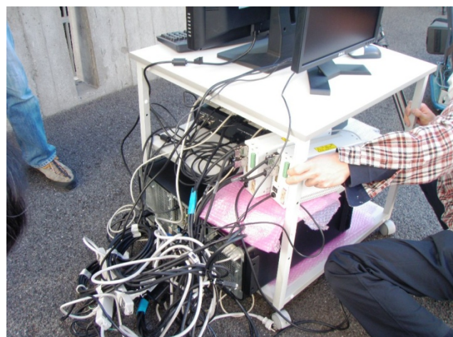
図 3-4.3-1 移動後の 3D システムの背面各機器の下に緩衝材を敷き、振動に対処する。
