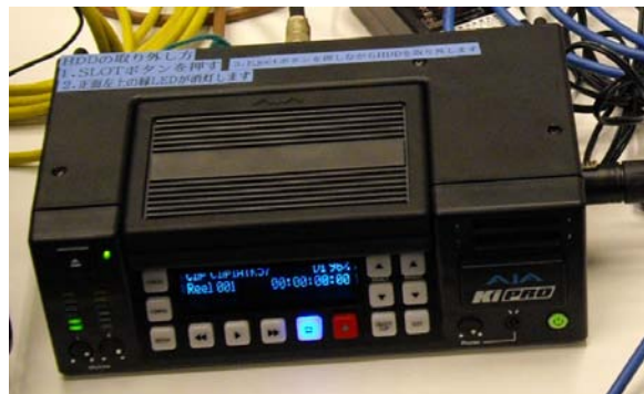
図3-3-3 KiPRO(2006年6月撮影時、仮編集用の1080/60i : サイドバイサイド収録に利用した)
