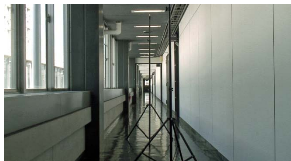
図3-3-15 インターアクシャルロック機能テストでの収録画像例 (フォーカス距離：約6m, コンバージェンス距離：約6m, インターアクシャル：67mm)
