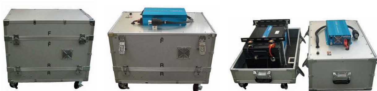
図3-1-7 電源ユニット格納ケース(外観とインバータとバッテリー)
