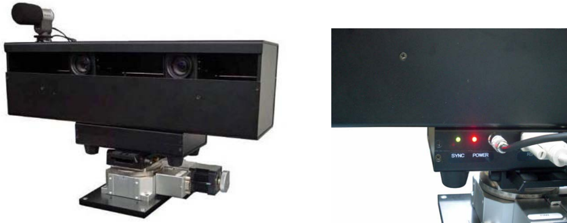
図3-1-2 改良したカメラユニットの外観とGENLOCK同期部
