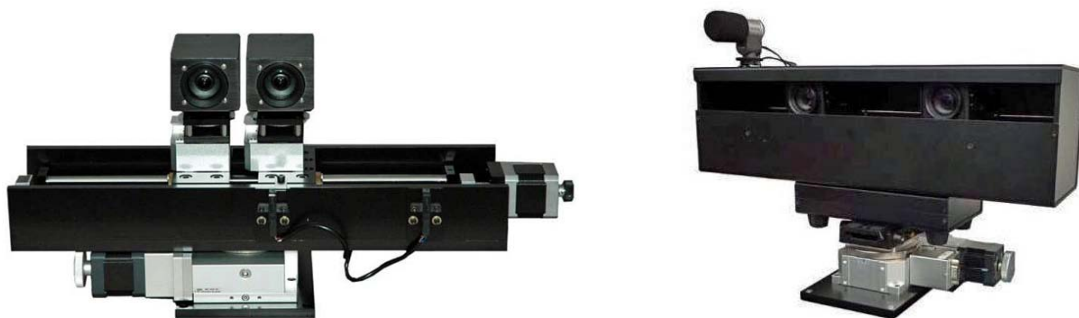
図3-1-1 平成21年度までのカメラ部(左)と平成22年度に改良したカメラ部(右)
