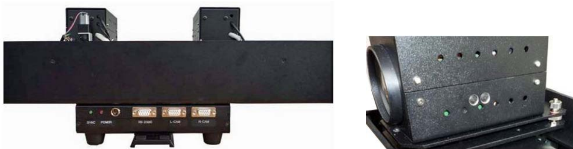
図3-1-3 上部外装を取り外したカメラユニット(左)と右眼用カメラの光軸ズレ調整部(右)
