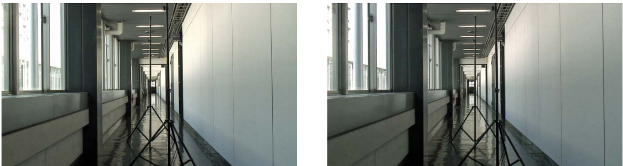
図3-3-6 フォーカスロック機能テストでの収録画像例 (フォーカス距離：約2m, コンバージェンス距離：約2.8m, インターアクシャル：90mm)
