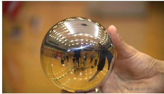
図 2.2-16 電光掲示板 IBL 用クロムボール撮影風景
