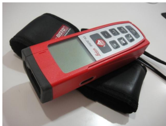
図 3.2-01 距離を測るためのレーザポインタ
