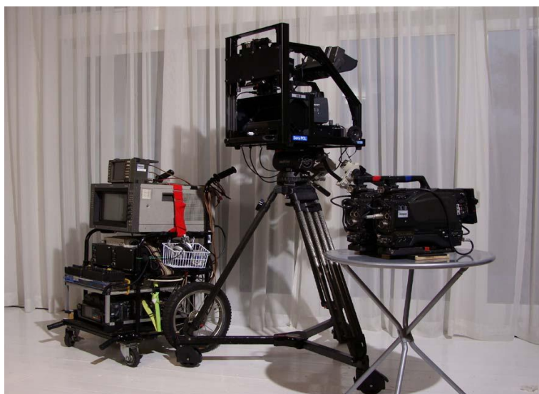
図 2. 2-03 撮影に使用した機器の外観（ハーフミラー型 3D リグ）
