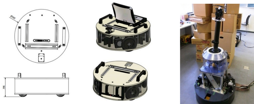
図 3.3-02 中型全方位置動台車（左）・遠隔操縦ロボット（右）
