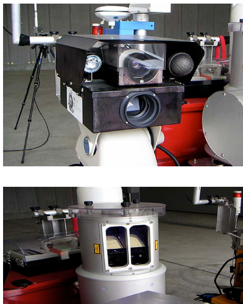
図-2.1-03 災害対応ロボットカメラ搭載図
