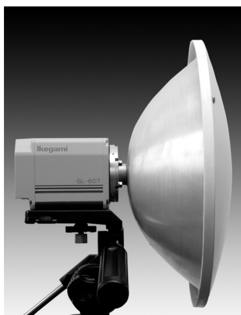
図 2.4-37 60GHz 帯の伝送装置例 2
