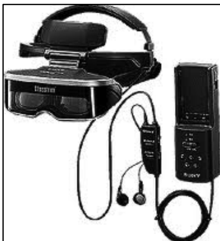
図 2.4-14 反射光学系を利用した HMD
