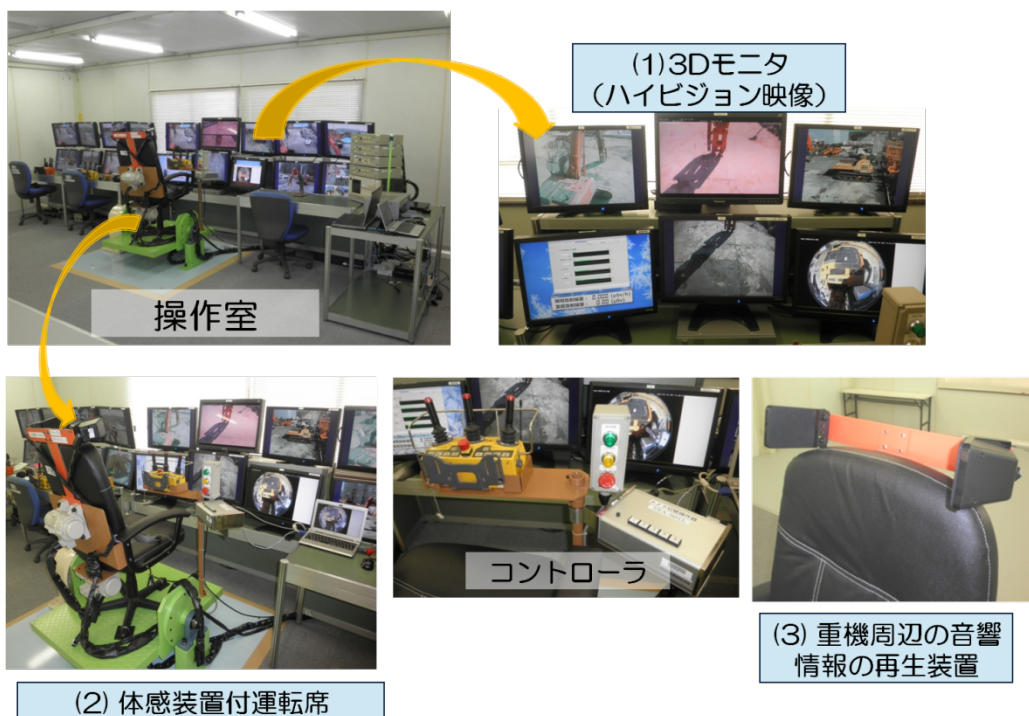
図 2.3-03 大林組における 3D 映像を利用した次世代無人化施工技術の実験
