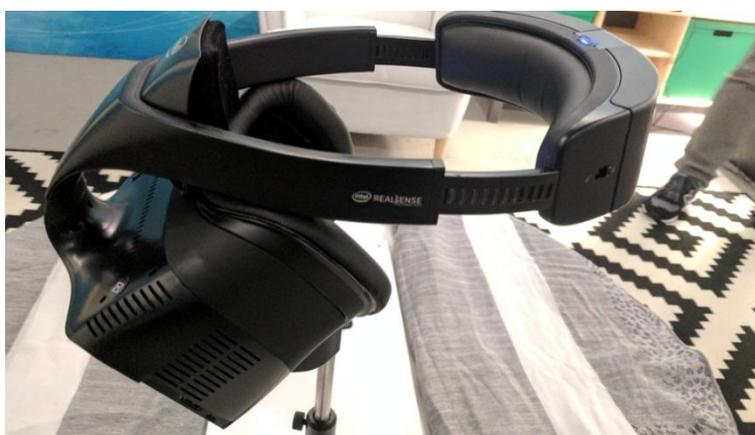
図 3.3-04 インテルが開発中の一体型 VR ヘッドマウントディスプレイ Project Alloy
