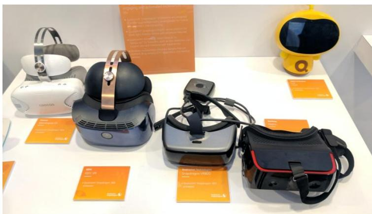
図 3.3-03 Qualcomm が提示したリファレンスモデル（右下）に基づき作成された一体型ヘッドマウントディスプレイ。いずれも中国製。
